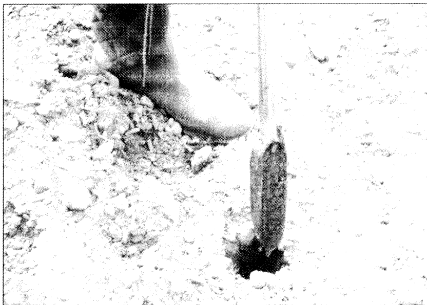
Figura 2. Prelievo del terreno effettuato con trivella manuale tipo olandese
